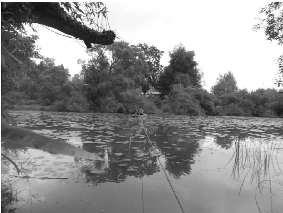
р. Каспля Исток, проведение гидрологических замеров - определение ширины реки
