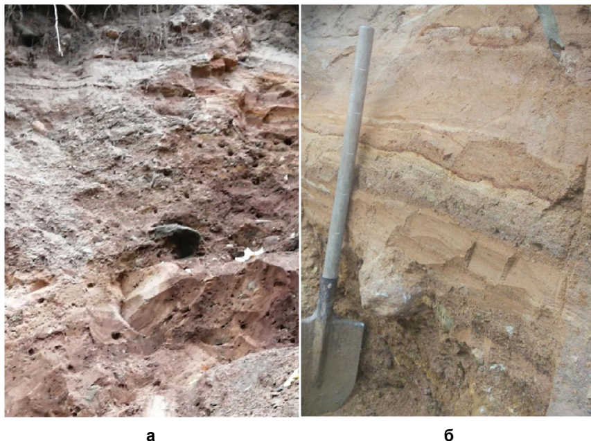
Рис. 2. Перекрывающие валунные глины сильно дислоцированные валунные супеси и суглинки (а) и горизонтально залегающие валунные супеси в верхней части разреза (б)
